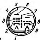
Рис. 142. Триод — пентод 6Ф1П и его цоколевка
